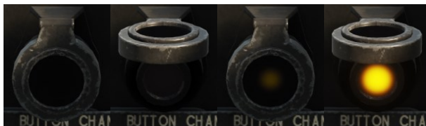
Рисунок 114: Лампа положения створок бомболюка, слева направо: бомболюк закрыт, крышка светофильтра закрыта; бомболюк закрыт, крышка светофильтра открыта; бомболюк открыт, крышка светофильтра закрыта; бомболюк открыт, крышка светофильтра открыта
