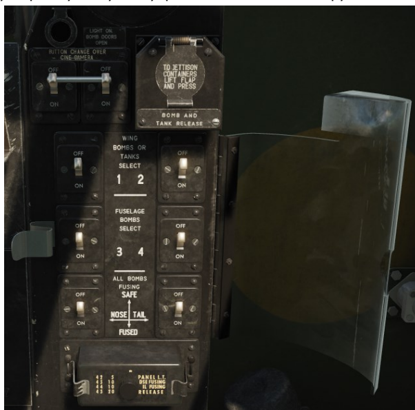
Рисунок 112: Пульт управления бомбовым вооружением, защитная крышка открыта Выбрать на пульте требуемые к сбросу подвески и способ их взведения.
