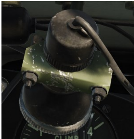
Рисунок 55: Лампа заливающего освещения передней панели с ультрафиолетовым светофильтром
