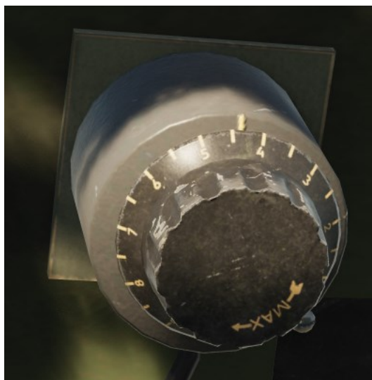
Рисунок 76: Настроечный реостат приводного приемника
