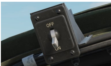
Рисунок 117: Тумблер залпового пуска в положении ON. Реактивные снаряды готовы к залповому пуску
