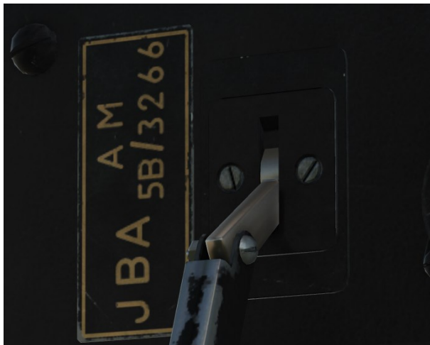
Рисунок 34: Главный выключатель бортовой электросети
