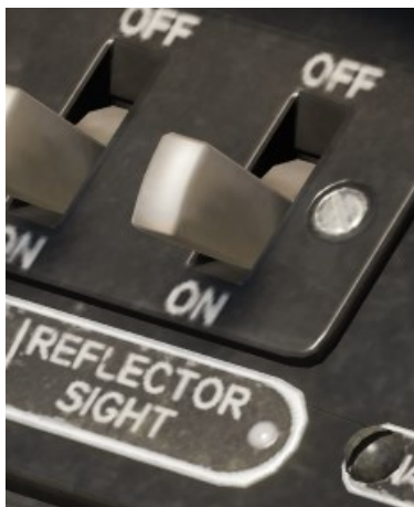
Рисунок 109: Тумблер включения прицела, положение ON
