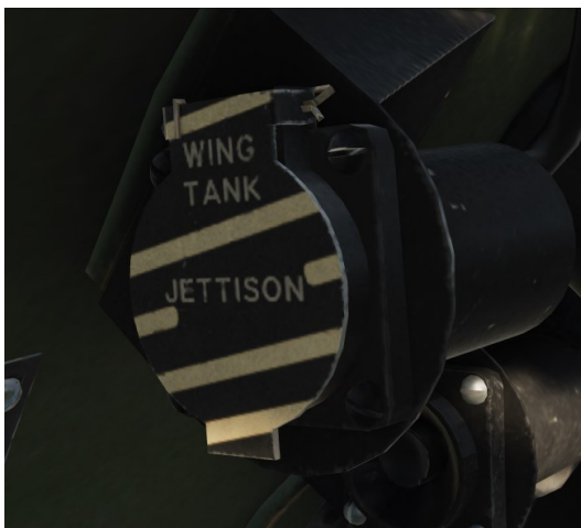
Рисунок 78: Кнопка сброса подкрыльевых баков под защитной крышкой
