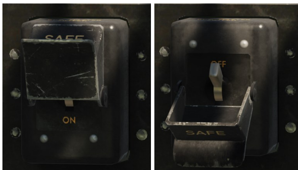
Рисунок 64: Тумблер включения вооружения, защитная крышка закрыта - слева, защитная крышка открыта - справа.
