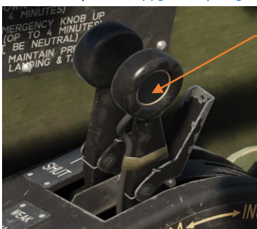
Рисунок 116: Кнопка запуска реактивных снарядов
